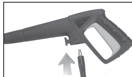
Prípojenie tlakovej hadice k striekacej pištoľi, Obr.6
