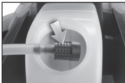
Filtr hadičky přísávání roztoku čistícího prostředku, Obr.10
