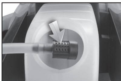
A tisztítószer felszívó cső és szűrő, 10. ábra
