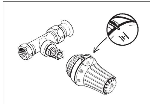
Pojistku proti odcizení lze vyjmout závitovým klíčem Danfoss.
